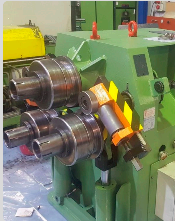
Rolado de Tubos
